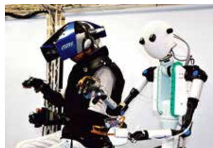
レイグジスタンスロボット Telesar V. この技術がTX incに移転され製品化に向けた開発が進められている。Telexistence robot Telesar V. This technology was transferred to TX inc and development is under way to commercialize it.
